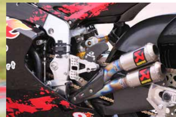
Kalex je opremljen Akrapovičevim ispušnim sustavom od titana (lijevo). Materijal i oprema iz svjetskog prvenstva, vidljiva je i Kalexova numeracija
